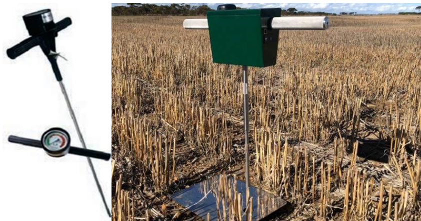
Рис. 27. Прилади для вимірювання твердості ґрунту
