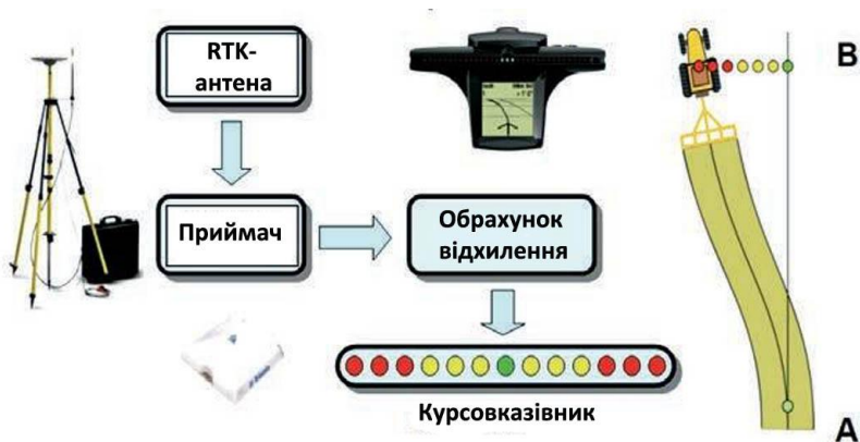
Рис. 4. Принцип функціонування курсовказівника
