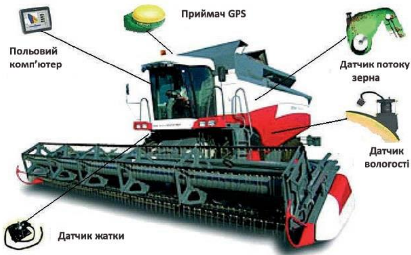
Рис. 30. Розташування обладнання для картування врожайності на зернозбиральному комбайні
