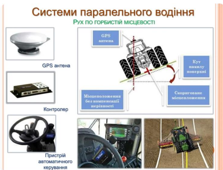
Рис. 5. Типовий склад системи паралельного водіння
