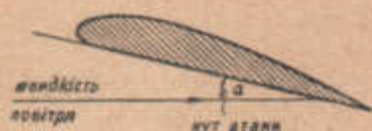
Рис. 159. Кут \alpha між хордою крила і напрямом потоку називається кутом атаки.
