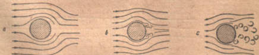
Рис. 147. а) Потік, який щойно почав обтікати циліндр. Вихри ще не утворилися. б) Потік, що обтікає циліндр невеликий час. Утворилося два вихри. в) Потік, що обтікає циліндр довгий час. Вихри відриваються і відносяться потоком.
