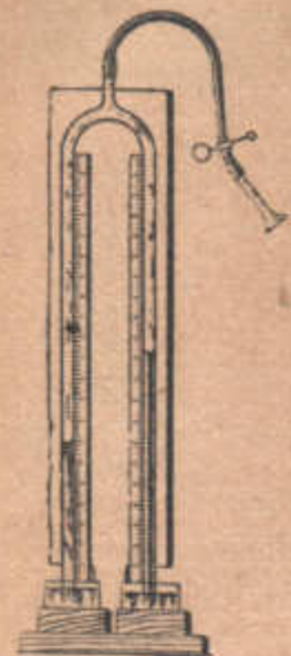
Рис. 103. Прилад Уатта для порівнювання густини рідин. Гумова трубка служить для висмоктування повітря.
