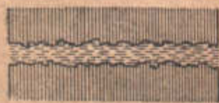
Рис. 46б. Змащування роз'єднує поверхні, які труться.
