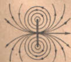
Рис. 113. Те саме течіння, що на рис. 112. Картина, яку бачить спостережник, нерухомий відносно рідини.
