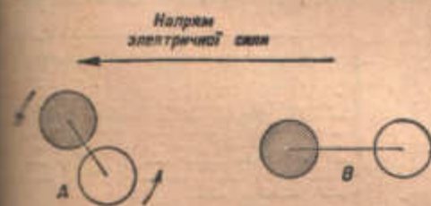
Рис. 279. Орієнтування і збільшення моменту диполя під дією електричної сили.
