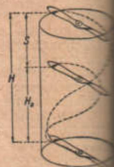
Рис. 167. Відстань— H , поступ— H_0 і ковзання— S гвинта.
