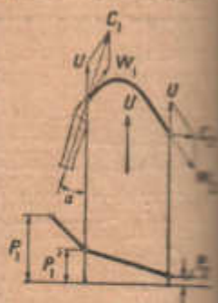
Рис. 269. Реактивна дія пари на лопатку турбіни.
