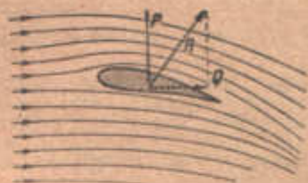
Рис. 158. Нормальний тиск розкладається на підіймальну силу P і індуктивний лобовий опір.
