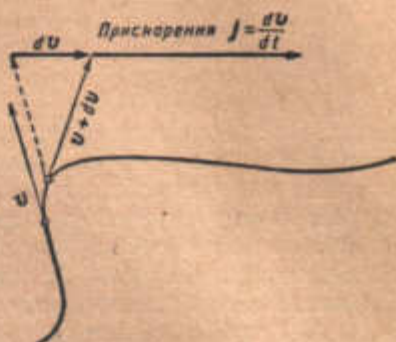
Рис. 15. При рівномірному русі вектор прискорення на криволінійних ділянках тим більший, чим більша кривизна.
