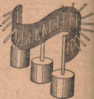
Рис. 275. Якщо зарядити сітку електрикою і вигинати її в ту й другу сторону, то прикріплені до неї тонкі папірці своїм відхиленням показують, що заряди розміщуються на зовнішній поверхні сітки.
