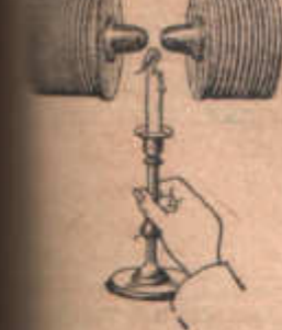
Рис. 288. Полум'я висмокчується з простору між полюсами магніта, коли між ними, як утворюють полюси, діамагнітні.
