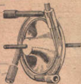
Рис. 267. Сопла і робоче колесо парової турбіни.
