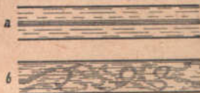
Рис. 114. а) Ламінарне і б) турбулентне течіння вздовж капілярної трубки.
