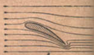
Рис. 153а. Швидкість повітря біля заднього крайка крила має дуже значну величину (на рисунку показано згущенням ліній течії).
