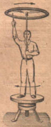
Рис. 84. Якщо ми піднімо велосипедне колесо над головою і надамо йому обертального руху, то сами разом з платформою почнемо обертатися в протилежний бік.
