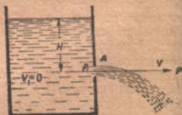
Рис. 124. Витікання рідини з отвору в стінці посудини.
