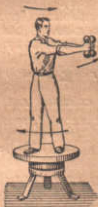
Рис. 83. Якщо зробити рух руками в один бік, ноги разом з верхньою платформою осалінчика повернуться в другий бік.
