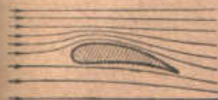
Рис. 155. Накладання циркуляції на зустрічний потік. Швидкість повітря, пропорційна густині ліній течії, над крилом буде більша, ніж під крилом.
