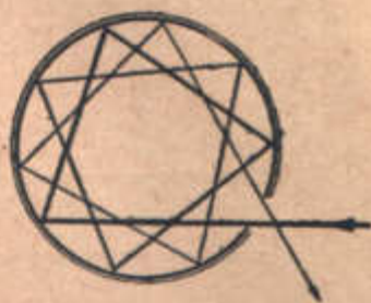
Рис. 215. Промінь, що попадає через невеликий отвір у вичорнену порожнину, майже цілком вбирається. А тому випромінювання такої порожнини банзьяке за характером до випромінювання абсолютно чорного тіла.
