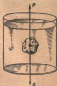
Рис. 104. До закону Архімеда. G — вага тіла, P — підіймальна сила, що дорівнює вазі витиснутої тілом рідини.
