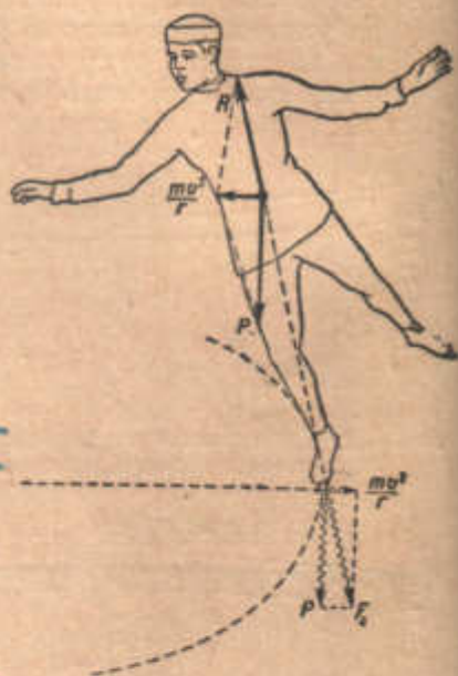
Рис. 33. Описуючи дугу кола, конькобежець нахилує свій корпус так, щоб реакція R льоду проходила через його центр ваги; тоді рівнодійна реакції R і ваги P дає доцентрову силу.
