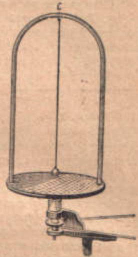
Рис. 6. При обертанні відцентрової машини площина коливання маятника залишається незмінною.
