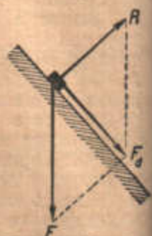
Рис. 26. Рушійна сила F_d є рівнодійна прикладених до тіла сил: сили F і реакції опори R .
