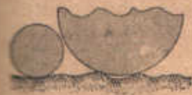
Рис. 48. Великі колеса дають меншого опору катання, ніж малі.
