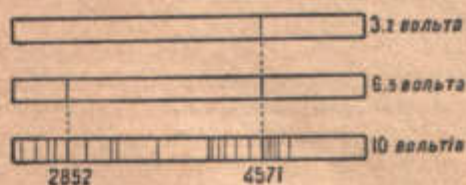
Рис. 642. Збудження спектра магнію електронами різних швидкостей.
