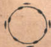
Рис. 607. Рентгенограма з прокатої срібляної пластинки (волокниста структура).
