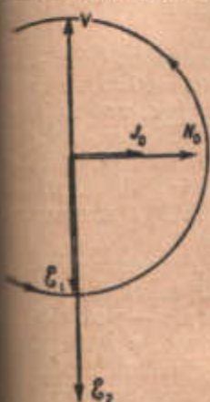
Рис. 387. Векторна діаграма трансформатора на холостому ході.
