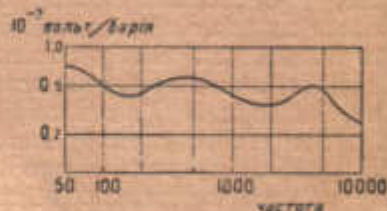
Рис. 493. Коефіцієнт перетворення стрічкового (електродинамічного) мікрофона як функція частоти.
