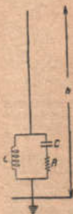
Рис. 461. Вертикальна приймальна антена з коливним контуром, який служить для її настройки.
