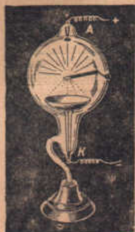
Рис. 401. Якщо з допомогою вгнутого катода сконцентрувати катодне проміння на платиновій пластинці, то платина розжарюється і може бути навіть розтоплена.
