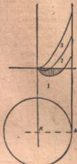
Рис. 451а. Розподіл потенціала в електронній лампі.
