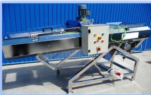
Рис. 10.10 Машина для відривання плодоніжки V-EA.1500
