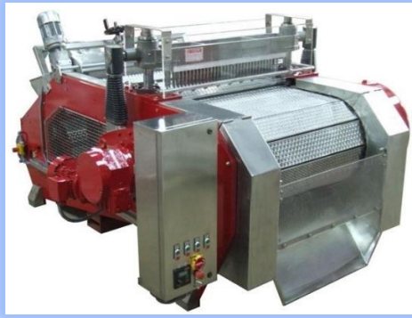
Рис. 10.12 Кісточко-вибивна машина AR-103
