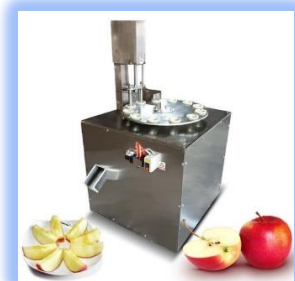
Рис. 10.11 Машина Vega Apl cor 800 A для нарізання яблук та видалення серцевини
