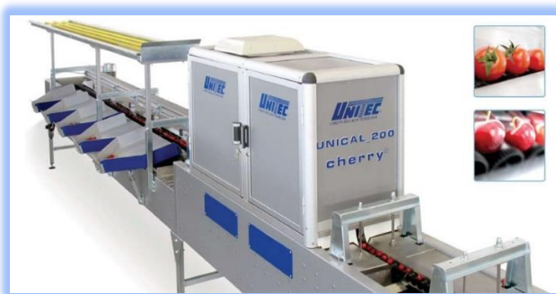
Рис. 10.8 Електронний сортувальник UNICAL-200 CHERRY MONO
