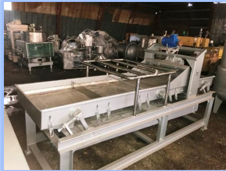
Рис. 10.3 Мийно-струшувальна машина UNIMATIK
