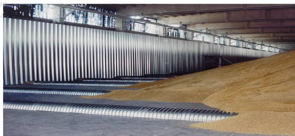
Рис. 5.3. Передпосівне прогрівання насіння рису в зерносушарках
