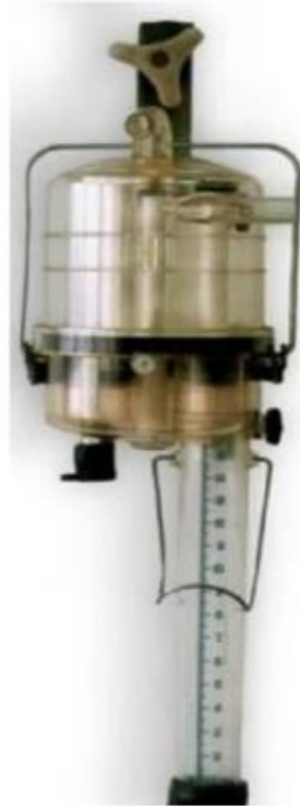
Рис. 3.7 - Пристрій зоотехнічного обліку молока УЗМ-1А: I, II – відповідно приймальна і вимірювальна камери; 1, 14 – скоби; 2, 17 – клапани; 3 – вкладиш; 4, 13, 16 – гумові ковпачки; 5 – калібрований отвір; 6 – прозорий ковпачок; 7 – трубка відведення молока; 8 – трубка для відведення молока в мензурку; 9 – розподільник; 10, 19 – прокладки; 11 – гумовий корок; 12 – фіксатор; 15 – мензурка; 18 – камера; 20 – отвір впуску повітря; 21 – фільтр; 22 – поплавець; 23 – отвір і сідло поплавця; 24 – канавка; 25 – трубка відсмоктування повітря; 26 – патрубок надходження молока; 27 – патрубок підведення молока; 28 – верхній звужений отвір
