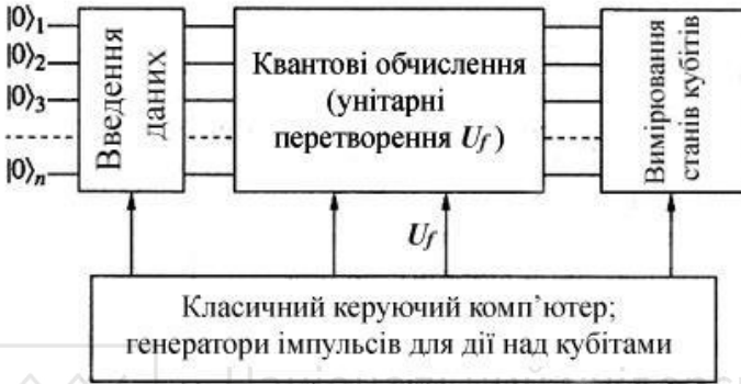
Рис. 2.5. Квантовий комп'ютер складається з n кубітів і дозволяє проводити одно- і двокубітні операції над будь-яким з них (або будь-якою парою). Ці операції виконуються під впливом імпульсів зовнішнього поля, керованого класичним комп'ютером
