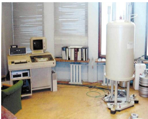
Рис. 4.3 ЯМР – спектрометр високої роздільної здатності фірми Bruker, який використовується для виконання багатьох видів квантових операцій на ансамблях органічних молекул
