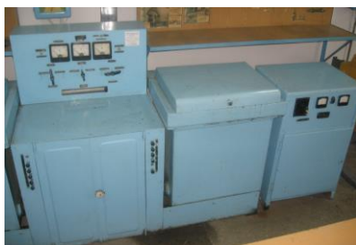
Рис. 5.2. Загальний вигляд лабораторної установки для нанесення гальванічних покриттів (хромування):
