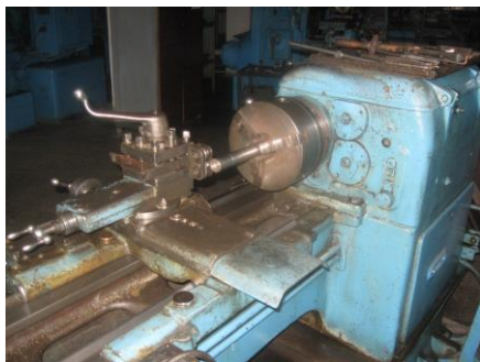
Рис. 4.4. Кулькова жорстка накатка та її встановлення у різцетримачі токарного верстата: 1 – державка; 2 – гайка; 3 – центрувальний гвинт; 4 – сепаратор; 5 – кулька (деформуючий елемент); 6 – корпус; 7 – шарикопідшипник; 8 – обойма кульки
