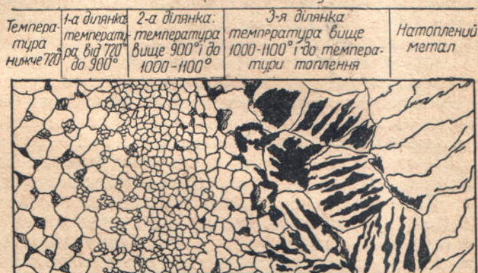
Фіг. 46. Мікрошліф зварного шва
