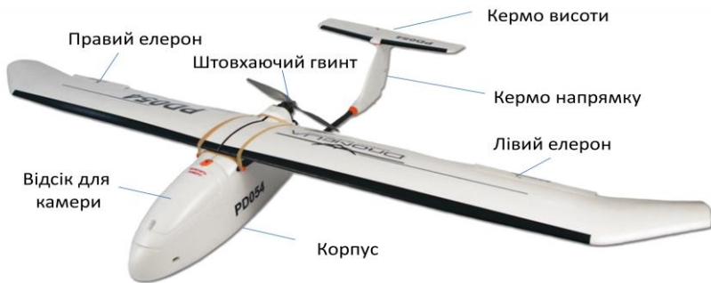
Рис. 1.11. Будова БПЛА літакового типу PD 1900
