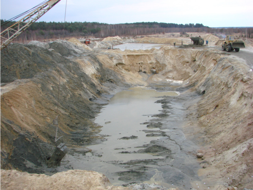
Рис. 6.2. Траншея, що розкрила бурштиновміщуючі піски (темно-сірого кольору) на родовищі Володимирець Східний
