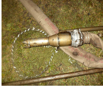
Рис. 6.10. Засоби видобутку бурштину способом підземного гідровимивання
