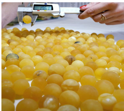
Рис. 9.4. Вимірювання розмірів бурштинового намиста штангенциркулем
