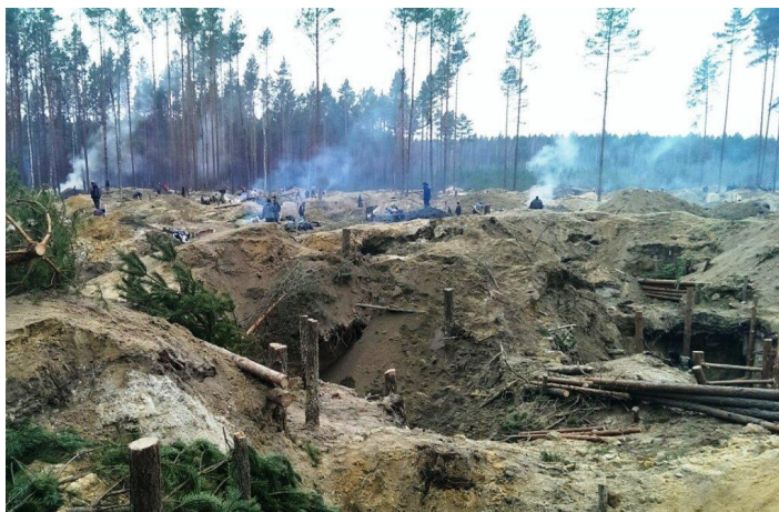
Рис. 6.8. Старательський видобуток бурштину шурфами з верхньої частини олігоценового покладу на Поліссі
