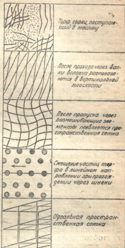
Рис. 15. Схема изменения структуры торфа в результате правильной переработки.
