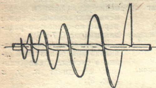
Рис. 8. Шнек с переменным аксиально-радиальным шагом.
