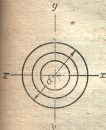
Рис. 30. Концентрические кривые давления массы при круглом сечении мундштука.
