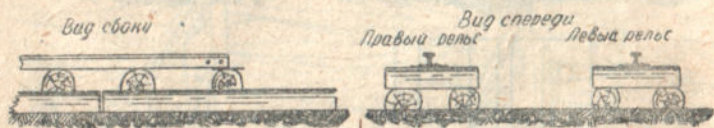
Рис. 3. Укладка ширококолейного настила машины.
