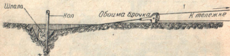
Рис. 11. Крепление якоря натяжной тележки.
