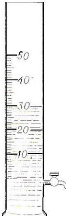
Рис. 3.1. Циліндр для визначення прозорості води
