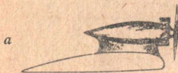
Фиг. 8а. Малая моторная гондола, соединенная с крылом посредством обтекателя с открытыми цилиндрами в положении В-1-А.
