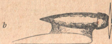
Фиг. 8б. Малая моторная гондола с кольцом № 3, соединенная с обтекателем и крылом в положении В-1-А.
