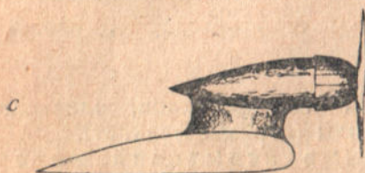
Фиг. 8с. Малая моторная гондола, обрuch с переменными углами ( -8^\circ ), соединенная посредством обтекателя с крылом в положении А-1-А.
