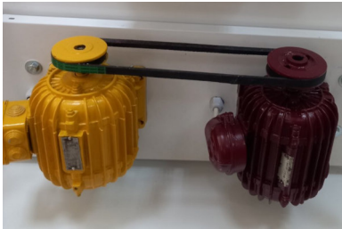
Рисунок. Обладнання лабораторного стенда для дослідження функціонування двигунного навантаження: а – комутаційна панель; б – асинхронні двигуни; в – пункт розподілу електроенергії ПР-11
