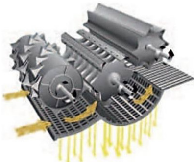
Рисунок. Молотильно-сепаруючий пристрій зернозбирального комбайна MEGA фірми CLAAS
