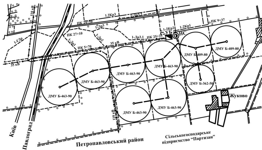
Рис. 3.11. Схема закритої зрошувальної мережі з дощувальними машинами «Фрегат» трьох модифікацій: ДМУ Б 463-90; ДМУ Б 409-80; ДМУ А 362-50
