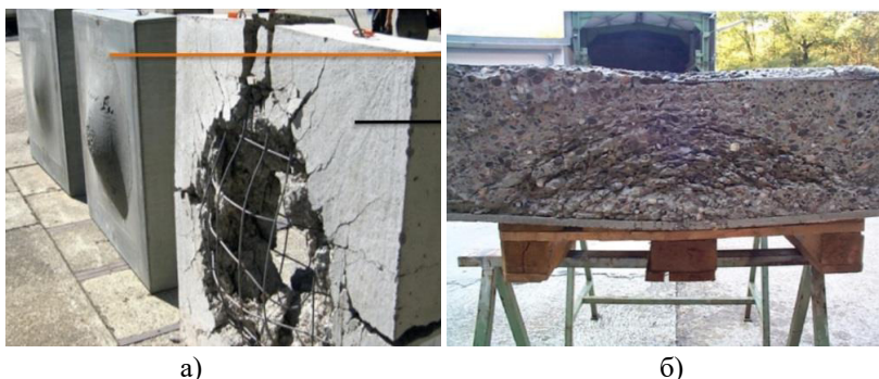
а) б) Рис. 5.2. Результат випробувань вибухом залізобетонних плит, підсилених і не підсилених за допомогою РПБ (а) та залізобетонна плита із захисним шаром РПБ, для захисту від утворення уламків при руйнуванні (б). (РПБ торгової марки DUCON® (Німеччина))
