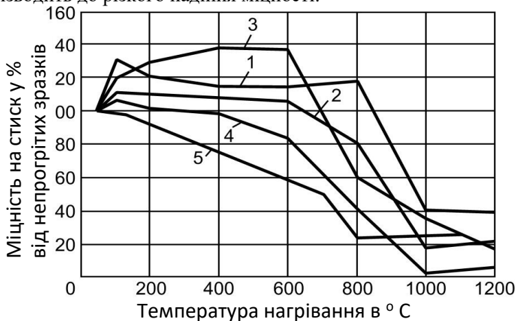
Рис. 2.9. Зміна міцності на стиск цементного каменю при нагріванні залежності від виду тонкомеленої добавки (співвідношення портландцемент: тонкомелена добавка - 1:1 за масою для всіх складів, а для складу з хромітом 1:0,5) 1 – портландцемент з шамотом; 2 – з меленим кварцом; 3 – з меленим гранульованим шлаком; 4 – з хромітом; 5 – без добавок
