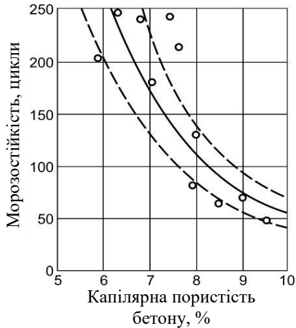
Рис. 6.12. Залежність морозостійкості бетону від капілярної пористості (за Г.І. Горчаковим)
