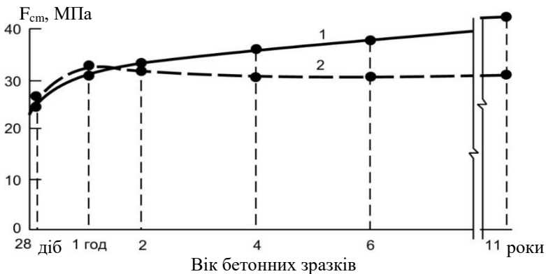
Рис. 6.2. Наростання міцності бетону в часі у вологій (1) і сухій (2) середовищі
