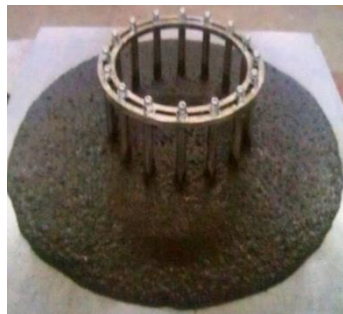
Рис. 4.13. Визначення розпливу конуса бетонних сумішей, які самоущільнюються: а – схеми і розміри лабораторного обладнання; б – бетонна суміш після завершення процесу розтікання
