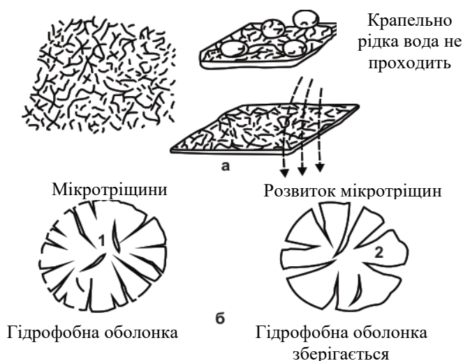
Рис. 2.12. Схематичне зображення змін, що відбуваються в зернах гідрофобного цементу при його зберіганні (а – решітчаста будова гідрофобних оболонки; б – гідрофобний цемент: 1 – свіжий; 2 – злежаний)
