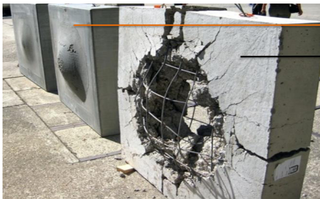
Рис. 8.1. Результат випробувань вибухом залізобетонних плит, підсилених і не підсилених за допомогою РПБ
