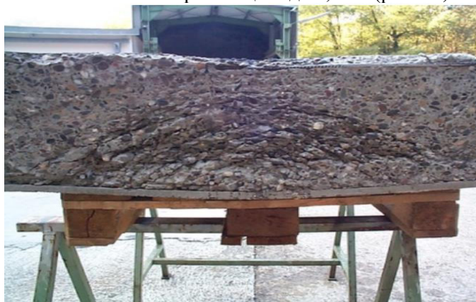
Рис. 8.2. Залізобетонна плита із захисним шаром РПБ, для захисту від утворення уламків при руйнуванні
