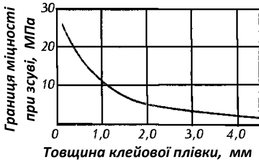
Рис.13.16. Залежність міцності склеювання сталі поліметилметакрилатом від товщини клейової плівки
