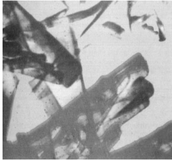
Рис. 6.22. Утворення кристалів еtringіту в гідратуючій цементній системі
