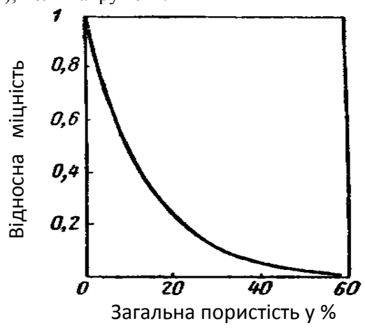
Рис. 4.14. Вплив пористості на міцність кераміки
