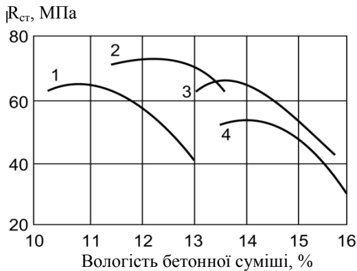
Рис. 8.9. Залежність міцності на стиск шлаколузного бетону від вологості суміші і масової частки глинистих частинок в заповнювачі: 1 – 1,2 %; 2 – 5,2 %; 3 – 6,4 %; 4 – 8,8 % (за даними Ж.В. Скурчинської)
