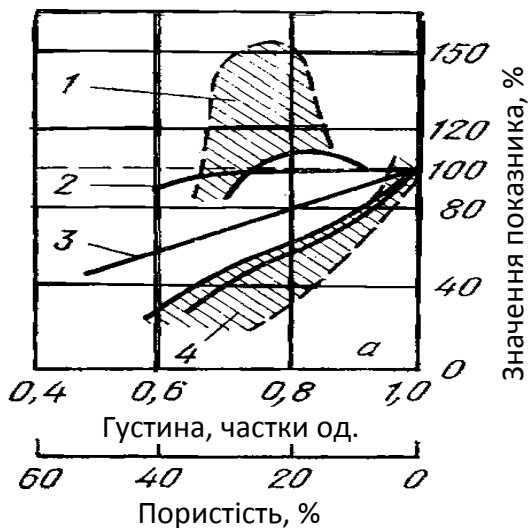
Рис. 4.15. Взаємозалежність пористості та деяких властивостей вогнетривких виробів: 1 – термостійкість; 2 – коефіцієнт теплопровідності; 3 – уявна густина; 4 – механічна міцність
