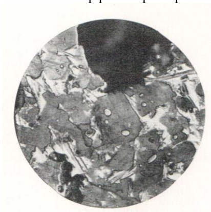
Рис. 6.16. Алітовий клінкер нерівномірностернистої структури
