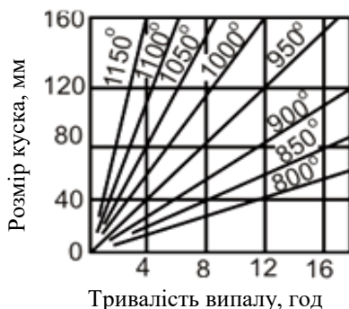
Рис. 6.6. Залежність тривалості випалу вапняку від температури і величини кусків
