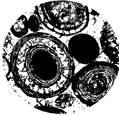
Рис. 3.16. Структура оолітового вапняку
