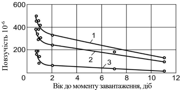
Рис. 7.38. Вплив віку бетону в момент завантаження на повзучість бетону на глиноземистому цементі: час під навантаженням: 1 – 100 дів; 2 – 28 дів; 3 – 1 доба
