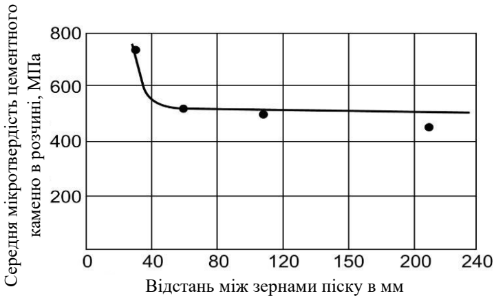
Рис. 7.24. Зміна мікротвердості цементного каменю в розчині в залежності від відстані між зернами піску
