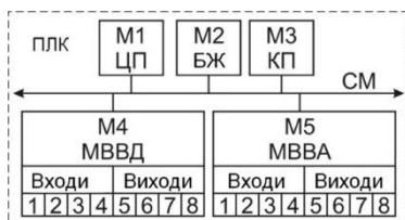
Рис. 1. Блочна структура модульного ПЛК
