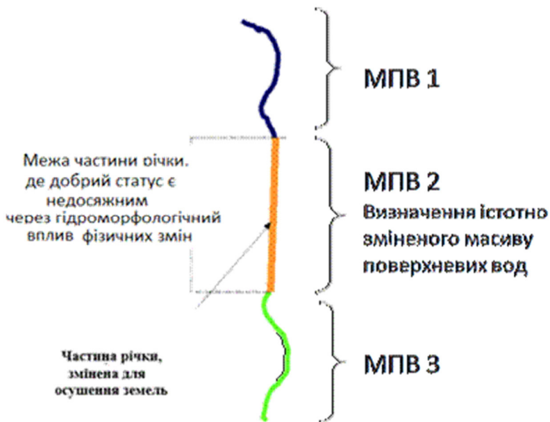
Рис. 4.5. Схема визначення масивів поверхневих вод з урахуванням гідроморфологічних змін
