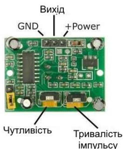
Рис. 7.2. Призначення контактів датчика руху HC-SR501 Активний рівень сигналу на виході утримується впродовж часу, що задається підстроювальним резистором
