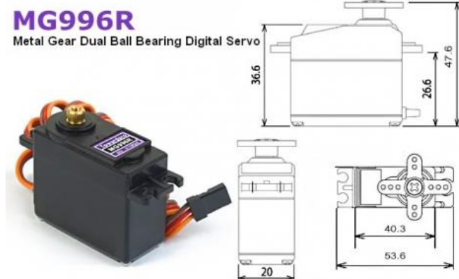
Рис. 6.4. Зовнішній вигляд та розміри сервопривода MG996R
