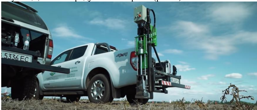
Рис. 1. Мобільний пробовідбірник на автомобільному шасі, SkokAgro, Україна
