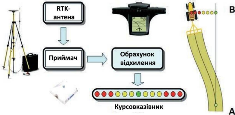
Рис. 1. Принцип функціонування курсовказівника
