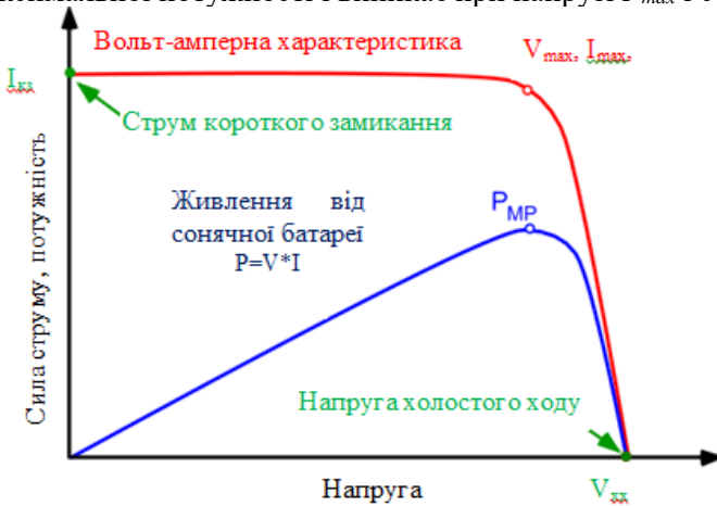
Рис. 3.1. Вольт-амперна характеристика сонячної батареї
