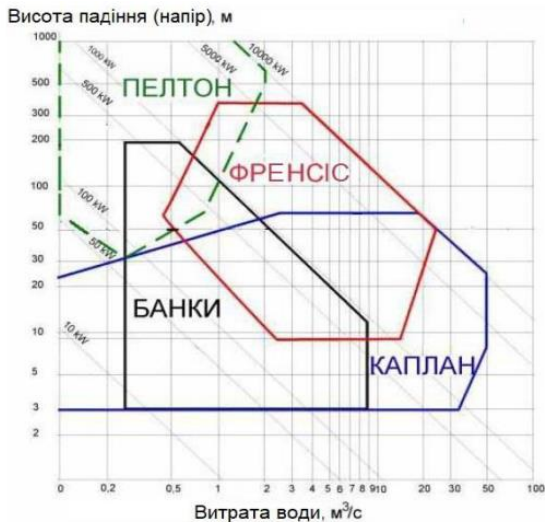
Рис. 7.1. Діапазони роботи турбін
