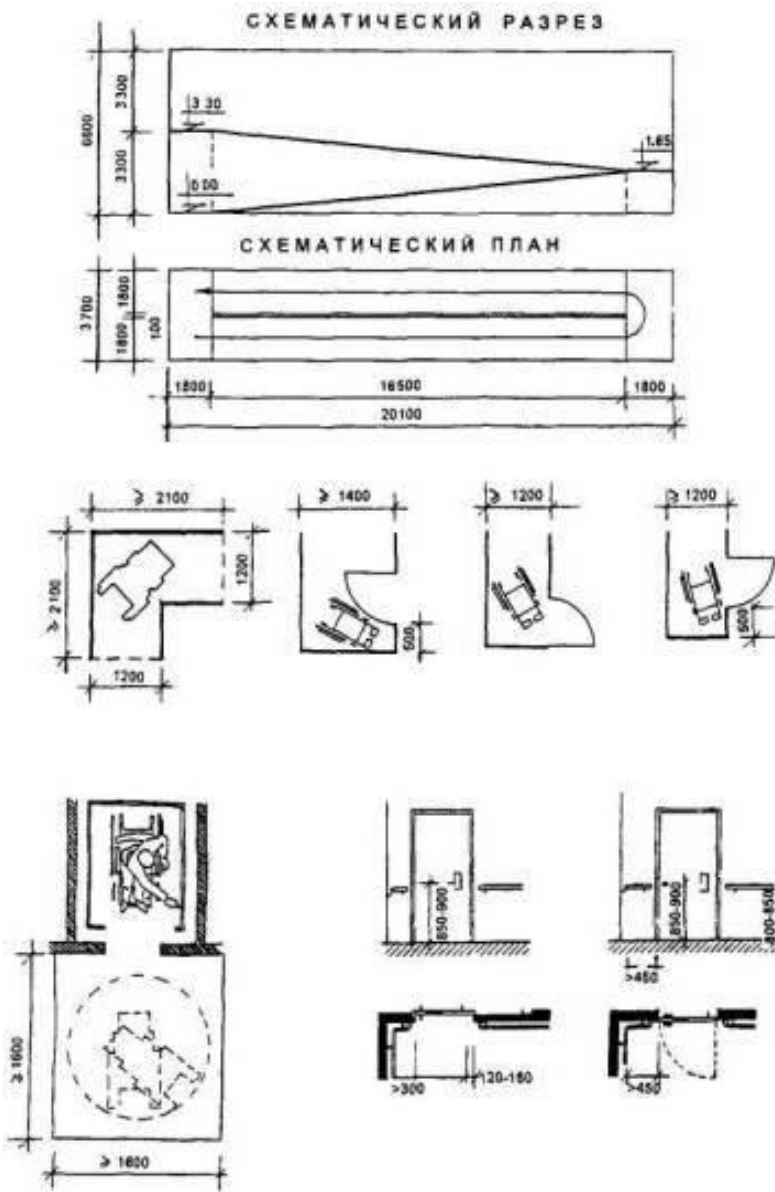
20. Параметри пандусів та розворотних площадок для осіб з інвалідністю кріслах колісних
