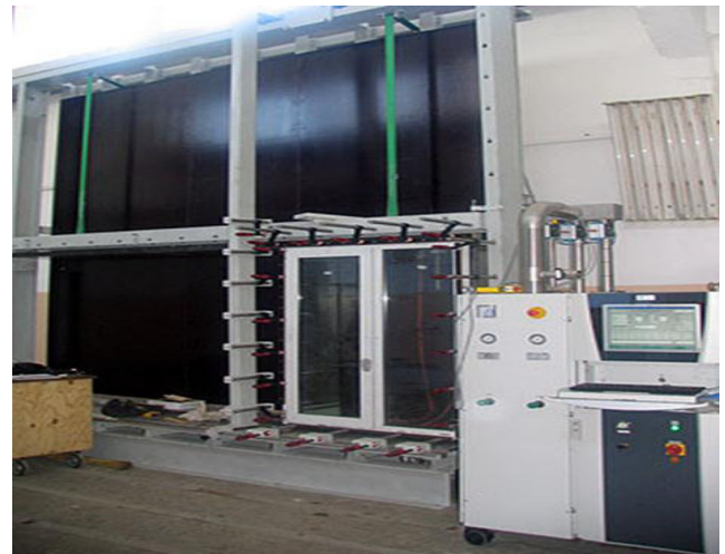
Рис.2. Експериментальні дослідження світлопрозорих конструкцій на повітропроникність
