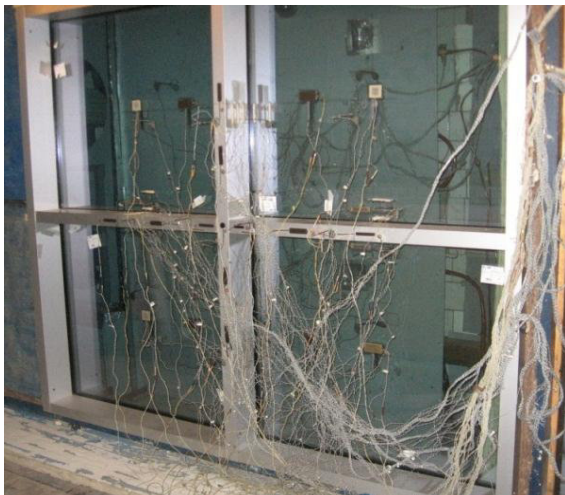
Рис. 1. Зовнішній вигляд дослідної конструкції під час проведення досліджень опору теплопередачі в кліматичній камері
