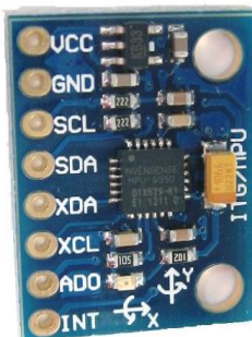
Рис. 3.1. Зовнішній вигляд модуля акселерометра-гіроскопа GY-521
