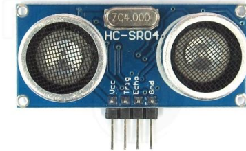
Рис. 2.5. Зовнішній вигляд сенсора HC-SR04
