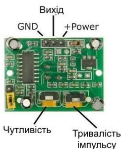
Рис. 6.2. Призначення контактів датчика руху HC-SR501
