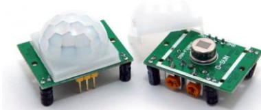
Рис. 6.1. Зовнішній вигляд давача руху HC-SR501
