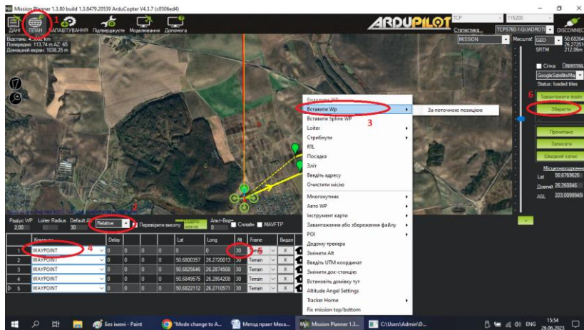
Рис. 7.1. Планування маршруту польоту в ArduPilot Mission Planner
