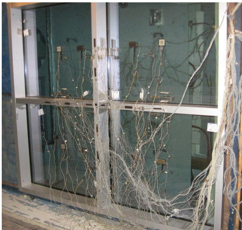
Рис. 2.9. Вид дослідної фасадної світлопрозорої конструкції під час експерименту
