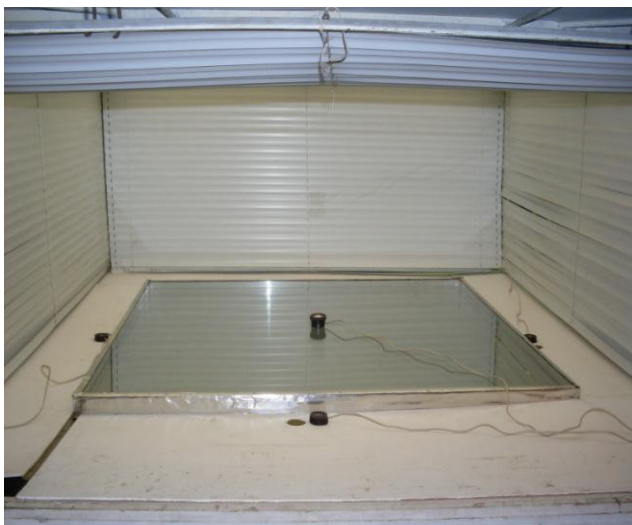
Рис. 2.16. Вид дослідних зразків у експериментальній установці: а – склопакета; б – віконної конструкції
