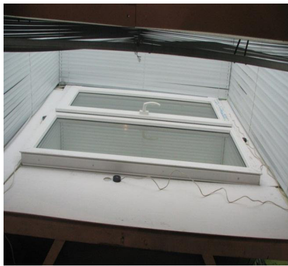
Рис. 2.16. Вид дослідних зразків у експериментальній установці: а – склопакета; б – віконної конструкції
