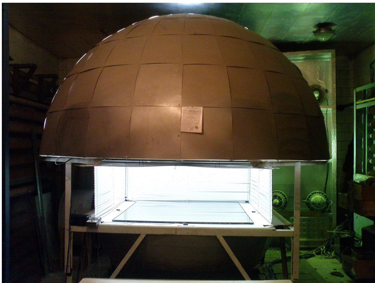
Рис. 2.15. Загальний вид експериментальної установки з визначення коефіцієнту направлено пропускання світла
