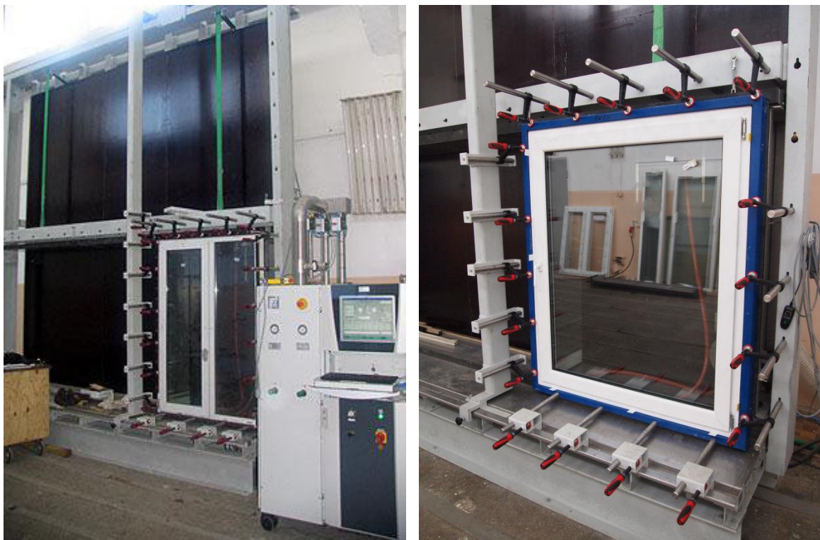
Рис. 2.13. Блок-схема експериментальної установки для випробувань повітропроникності світлопрозорих конструкцій
