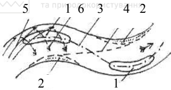
Рис. 1.3. План ділянки русла річки і структура річкового потоку на його вигині
