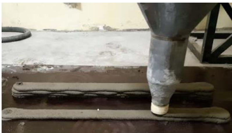
Рис. 2. Процес 3D-друку шляхом видавлювання один на одного шарів цементної суміші
