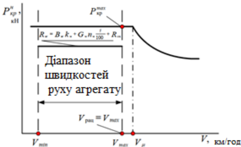
Рис. 5.2. Графічне визначення V_{рац} за умови V_{\mu} > V_{max}
