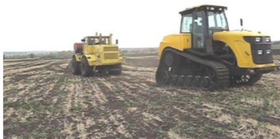
Рис. 6.1. Тягові випробування в русі: а – під час випробування трактора «Сталінець» з використанням тягового возика (1930 рік); б – із застосуванням динамометричної лабораторії ТЛ-3 (1960 рік); в – під час проведення випробувань за схемою «трактор тягне трактор» (2010 рік)
