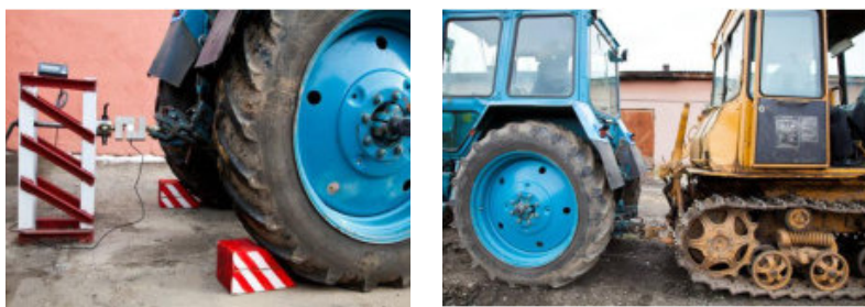
Рис. 6.3. Тягові випробування трактора під час рушання з місця під навантаженням: а – із застосуванням нерухомої опори; б – з використанням трактора в якості гальмівного устаткування за схемою «трактор тягне трактор»
