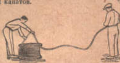
Фиг. 32. Неправильная размотка каната с барабана
