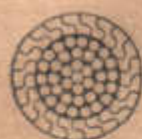
Фиг. 22. Канат закрытого типа с круглыми проволоками внутри
