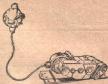
Электрооборудование конвейерного привода ДК-15
