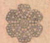
Фиг. 19. Круглый канат из трехгранных прядей (в прядях равнобедренные проволоки)
