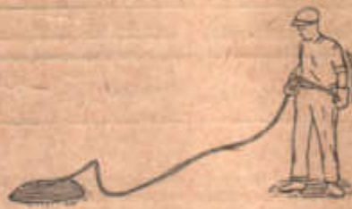
Фиг. 34. Неправильная размотка каната из бухты
