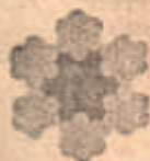
Фиг. 6. Канат конструкции 6 \times (7+1) о. с.
