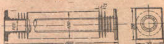
58325 Чугунная ребристая труба водяного экономайзера ЦКТИ
