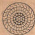
Фиг. 23. Канат закрытого типа с круглыми и трансверсальными проволоками внутри
