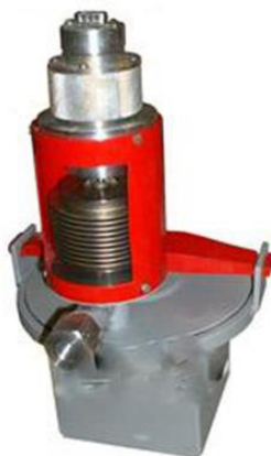
Рис. 3.10. Диференційний дилатометр ДОД-100К/З
