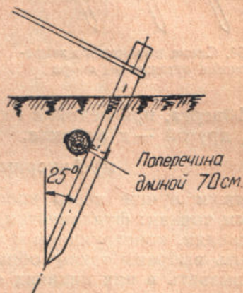
Рис. 63. Схема глухого закрепления оттяжки на якорь
