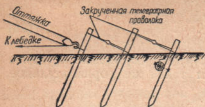
Рис. 64. Схема подвижного закрепления оттяжки на якоре
