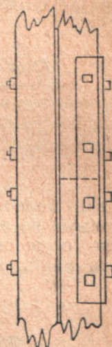
Рис. 54. Схема крепления стыка мачты
