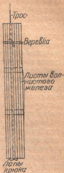
Рис. 207. Схема захвата листов волнистого железа при подъеме
