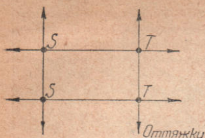
Рис. 133. Схема соединения и крепления верхушек мачт
