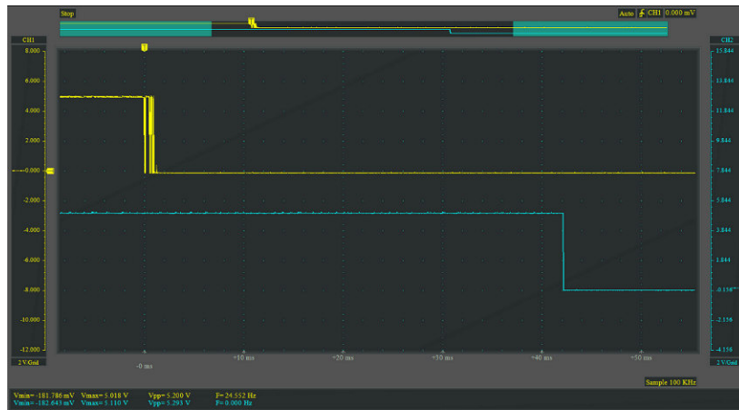
Рис. 1.129. Осцилограма сигналу з механічної кнопки (з брязкотом) та очищеного сигналу на виході мікросхеми MAX6816
