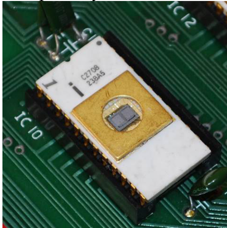
Рис. 1.75. EPROM, вміст якої витирається за допомогою ультрафіолетової лампи
