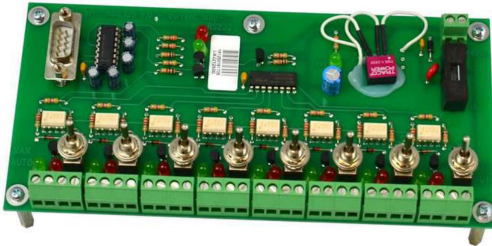
Рис. 1.149. Перетворювач інтерфейсу RS-232—«струмова петля», що дозволяє під'єднувати до 8 пристроїв зі струмовим колом
