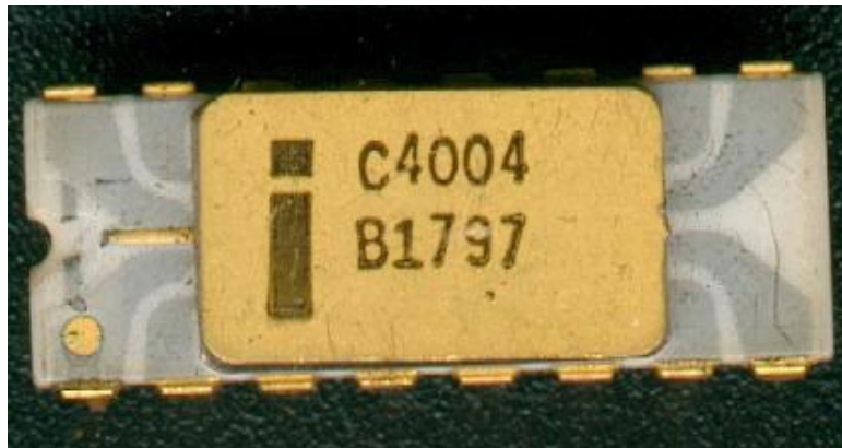
Рис. 1.8. 4-бітовий мікропроцесор Intel 4004, випущений корпорацією Intel у 1971 р.
