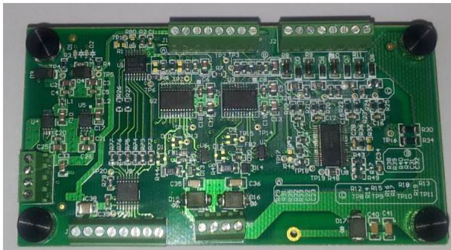
Рис. 1.44. Модуль TIDA-00310 введення-виведення аналогових сигналів
