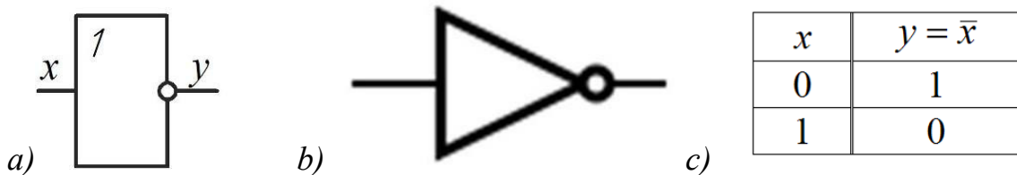
Рис. 1.20. Логічний елемент НІ (NOT): a – європейське позначення (IEC); b – американське позначення (ANSI); c – таблиця істинності
