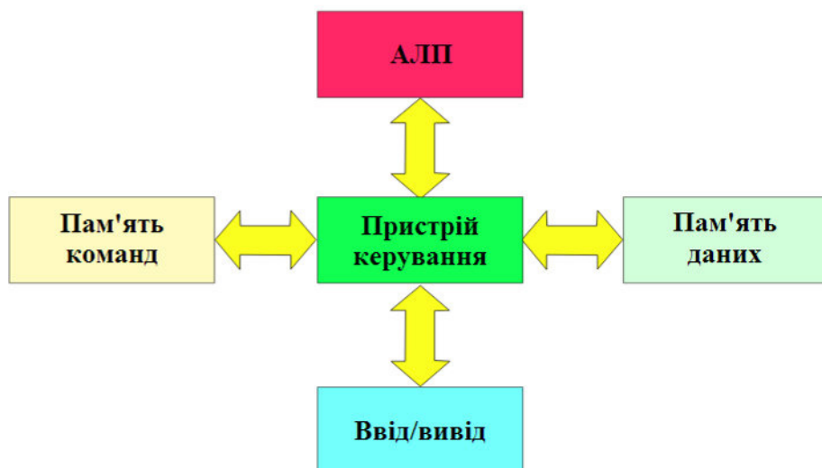
Рис. 1.10. Гарвардська архітектура обчислювальної машини
