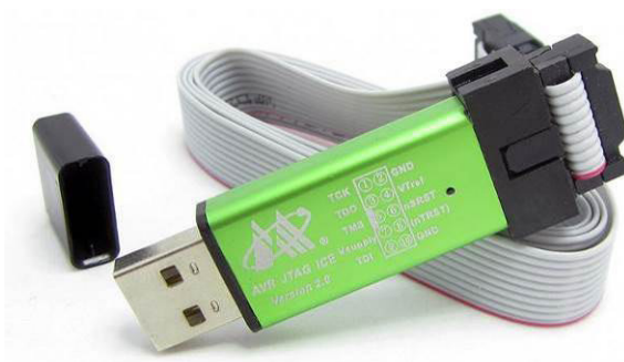
Рис. 1.105. Програматор AVR JTAG Atmel's AVR Studio ICE
