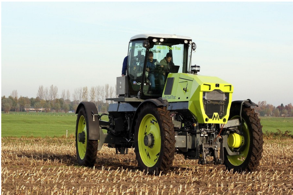
Рис. 13.4. Загальний вигляд електричних самохідних машин: а – автономний електротрактор серії T4 Electric Power компанії New Holland (Нідерланди); б – електротрактор фірми Fendt (Німеччина); в – електричний трактор SESAM компанії John Deere; г – повнофункціональний сільськогосподарський трактор на електричному ходу Multi Tool Trac (Нідерланди)
