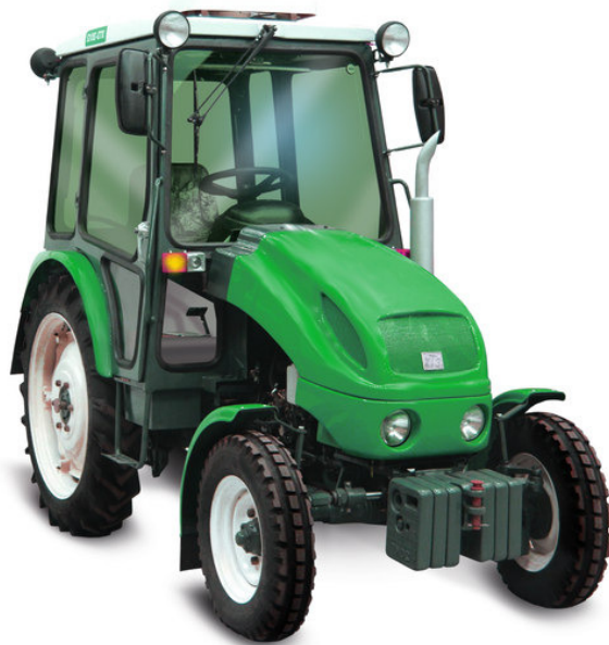
Рис. 13.5. Електротрактори українського виробництва: а – ХТЗ-2511 Electro на базі трактора ХТЗ-2511; б – ХТЗ-Edison на базі трактора ХТЗ-3512
