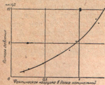
Рис. 207. Потеря давления сухого газометра при различных расходах воздуха.
