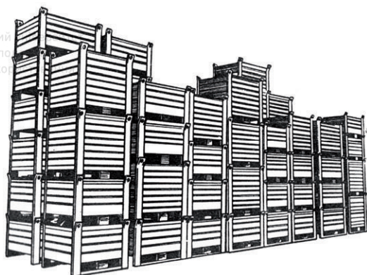
Рис. 5.4. Унифицированная тара многоразового использования для комплектующих изделий машиностроения (бесстеллажное хранение)
