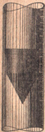
Рис. 205. Положение поплавка ротационного газомера во время измерения.
