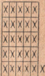
Рис. 164. Разбивка сечения при прямоугольного трубопровода для измерения средней скорости.
