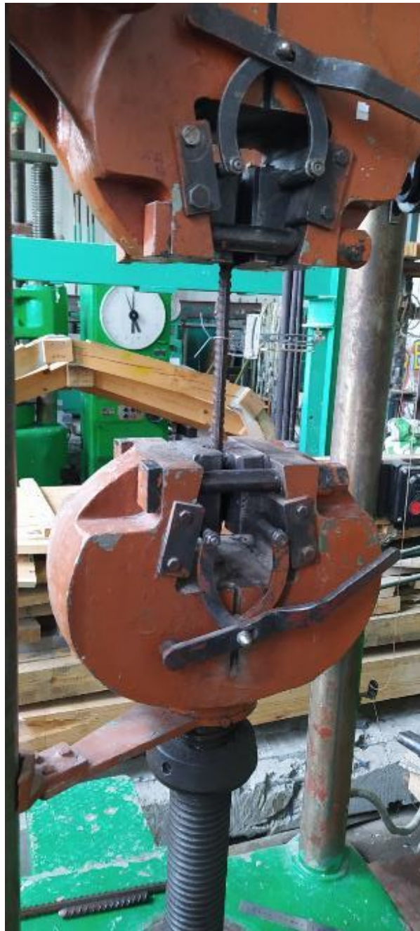
Рис. 2.10. Випробування арматурних стержнів у розривній гідравлічній машині УИМ-50
