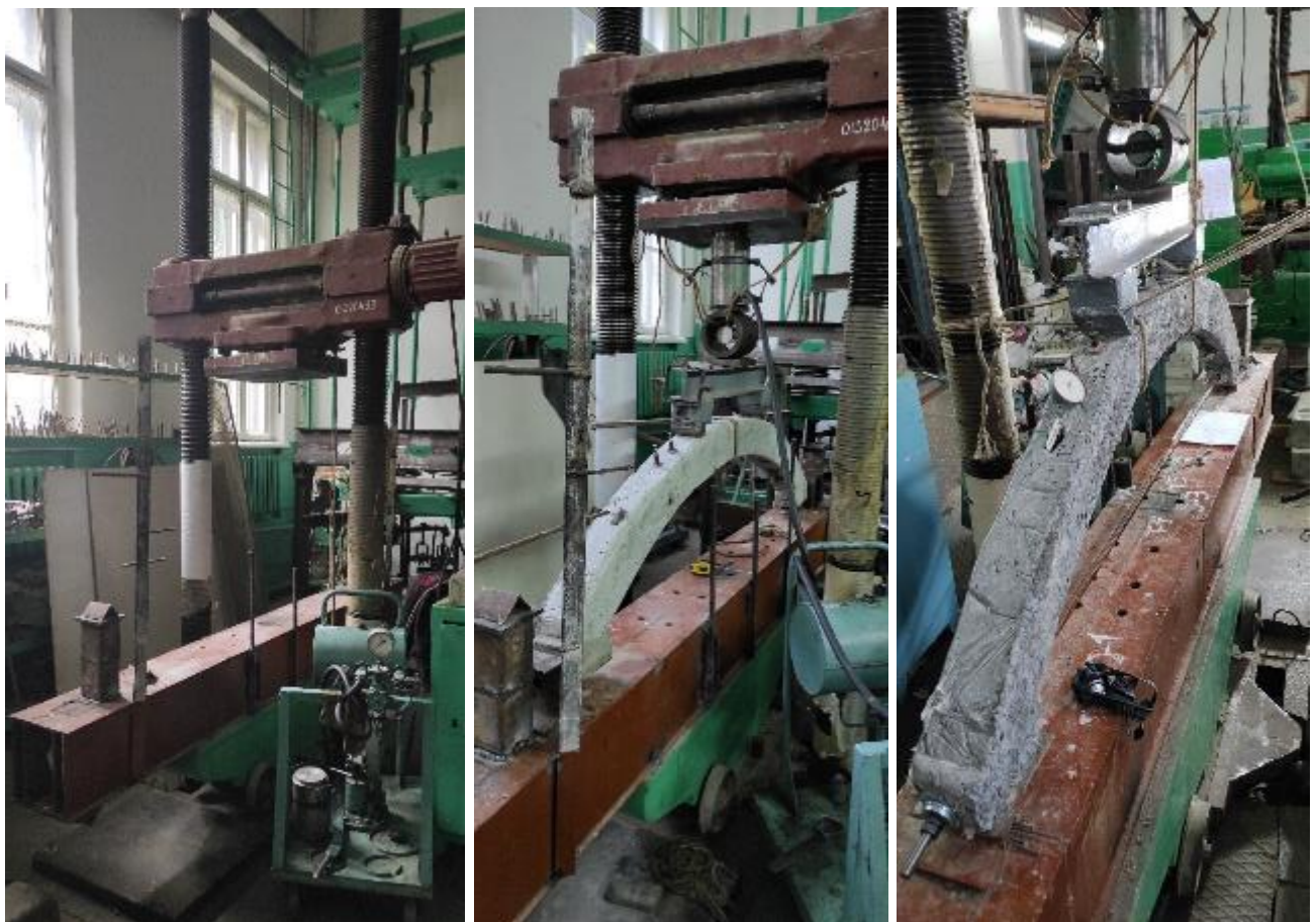
Рис. 2.18. Прес ПГ-200 з обладнанням для випробування дослідних арок
