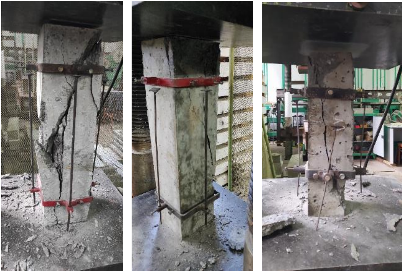
Рис. 2.13. Характер руйнування призмових зразків за дії осьового стиску
