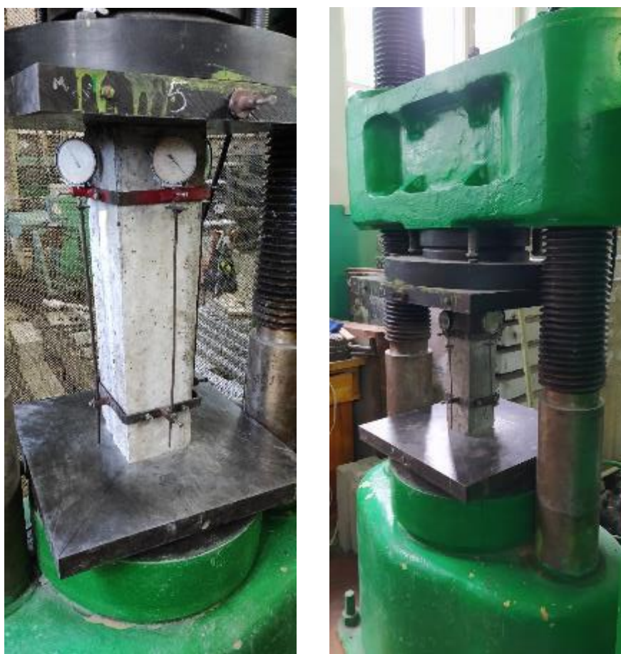
Рис. 2.12. Випробування призмових зразків на пресі П-250:
