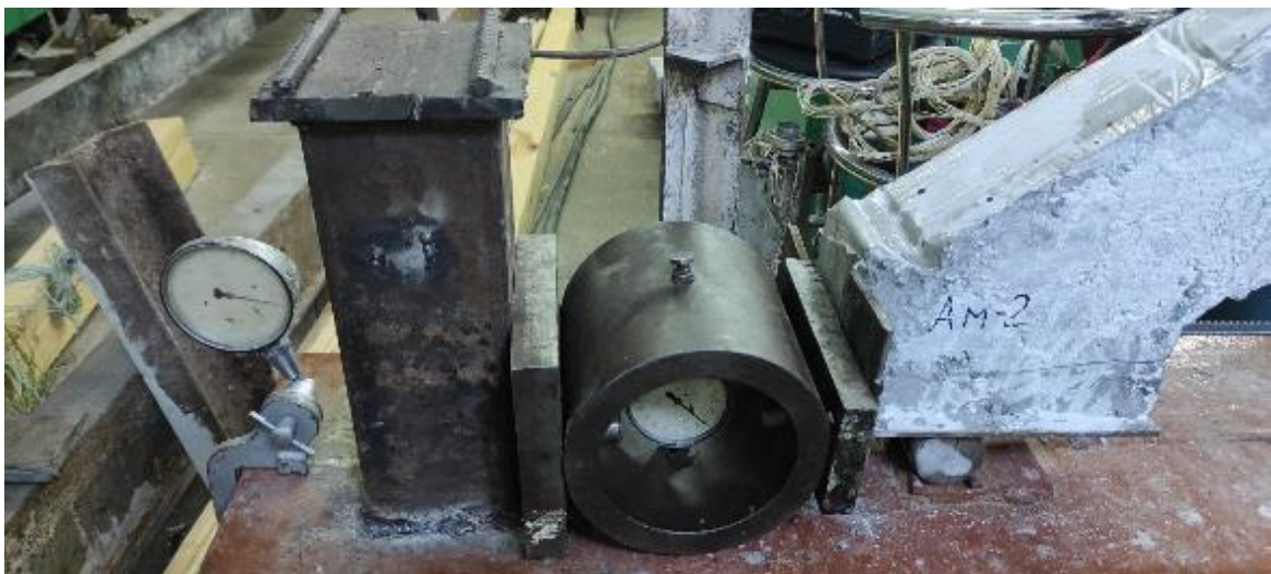
Рис. 2.22. Кільцевий динамометр Д-2 на шарнірно-рухомій опорі дослідної арки А1-1
