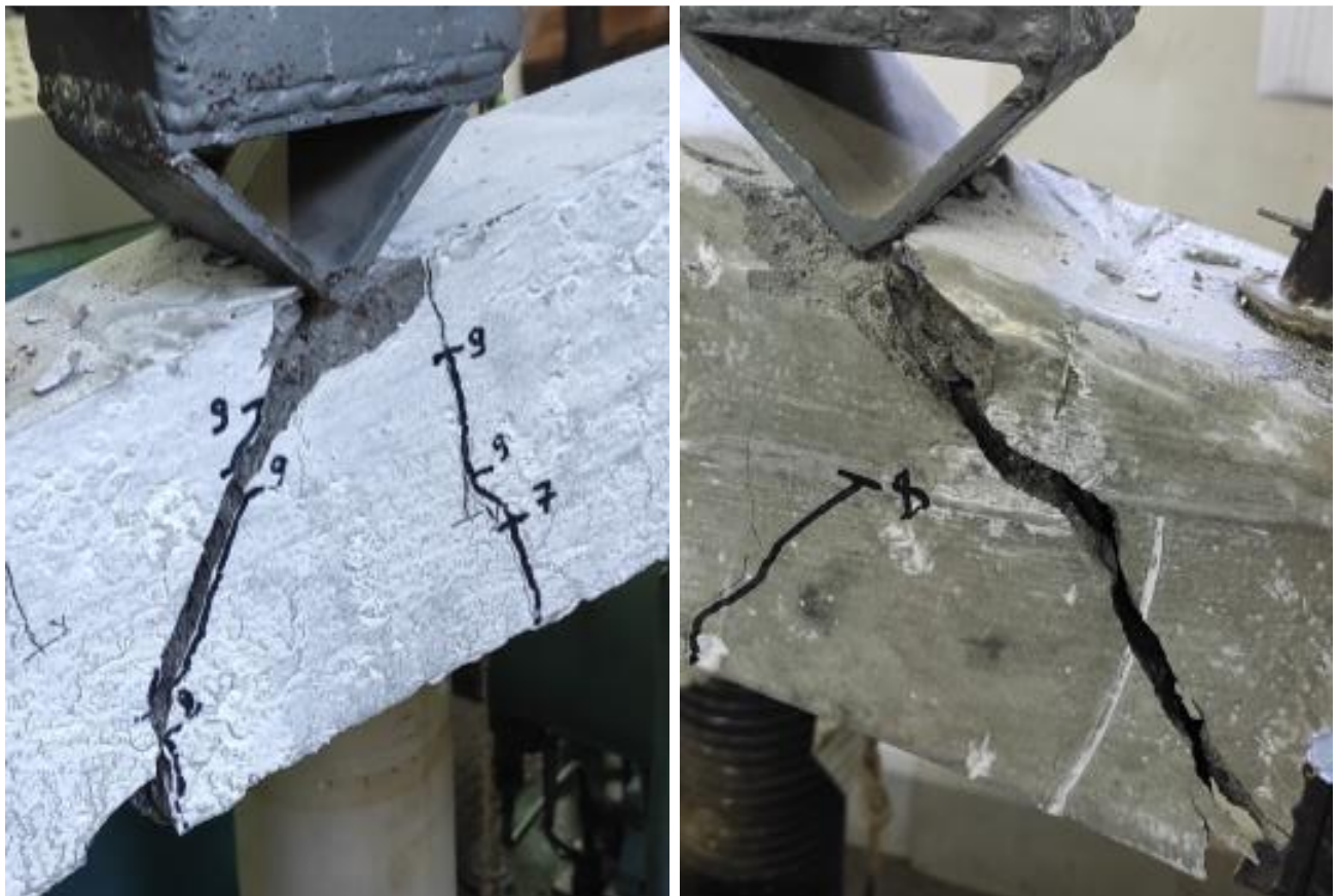
Рис. 3.14. Характер руйнування арки А1-2 та магістральна тріщина у її поясі
