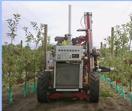
Рис. 9.23. Робот збирач яблук Abundant Robotics 18
