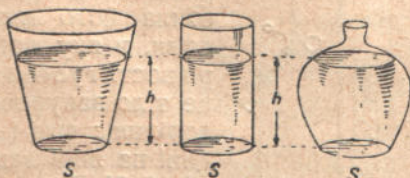
Рис. 101. Сила тиску рідини на дно посудин, зображених на рисунку, однакова (висоти рівнів однакові і площі основ рівновеликі).
