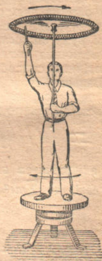
Рис. 84. Якщо ми піднімо велосипедне колесо над головою і надамо йому обертального руху, то сами разом з платформою почнемо обертатися в протилежний бік.
