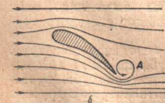
Рис. 153б. На початку руху біля заднього крайка виникає „розгонний вихор“.
