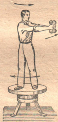
Рис. 83. Якщо зробити рух руками в один бік, ноги разом з верхньою платформою ослінчика повернуться в другий бік.
