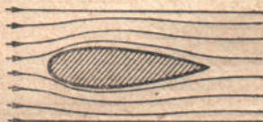
Рис. 149. Тіло легкообтічної краплеподібної форми не утворює в потоці вихрів і рухається без опору.
