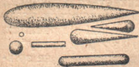
Рис. 148. Різні тіла, що мають однаковий лобовий опір.
