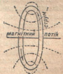
Рис. 318. Вигляд магнітного поля кругового струму в просторі.
