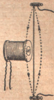
Рис. 333. Дія магнітного поля на м'який провід. При пропусканні струму вниз або вгору провід відхиляється до читача або від нього відповідно до правила лівої руки.
