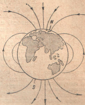
Рис. 285. Земля являє собою магніт. Магнітні полюси Землі не збігаються з географічними полюсами. На рисунку зображені, силові лінії магнітного поля Землі.
