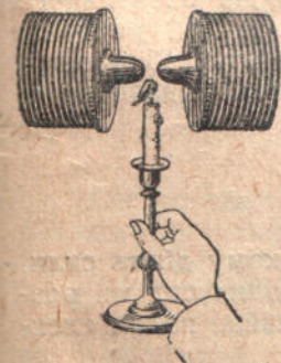
Рис. 288. Полум'я виштовхується з простору між полюсами магніта, бо газ, які утворюють полум'я, діамагнітні.
