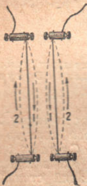
Рис. 340. Взаємодія двох паралельних струмів. Струми одного напрямку притягуються, струми протилежних напрямків відштовхуються.
