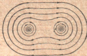
Рис. 341. Магнітне поле двох паралельних струмів одного напрямку.
