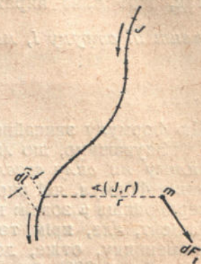
Рис. 320. До закону Біо і Савара. Дія елемента струму на магнітний полюс.
