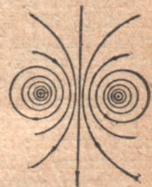
Рис. 342. Магнітне поле двох паралельних струмів протилежного напрямку.
