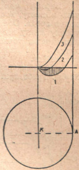
Рис. 451а. Розподіл потенціала в електронній лампі.
