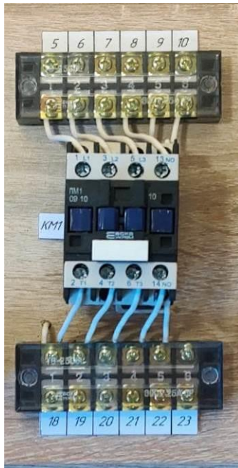
Рисунок 4.4 – Контактор ПМ1-09-10, призначений для проведення дослідів
