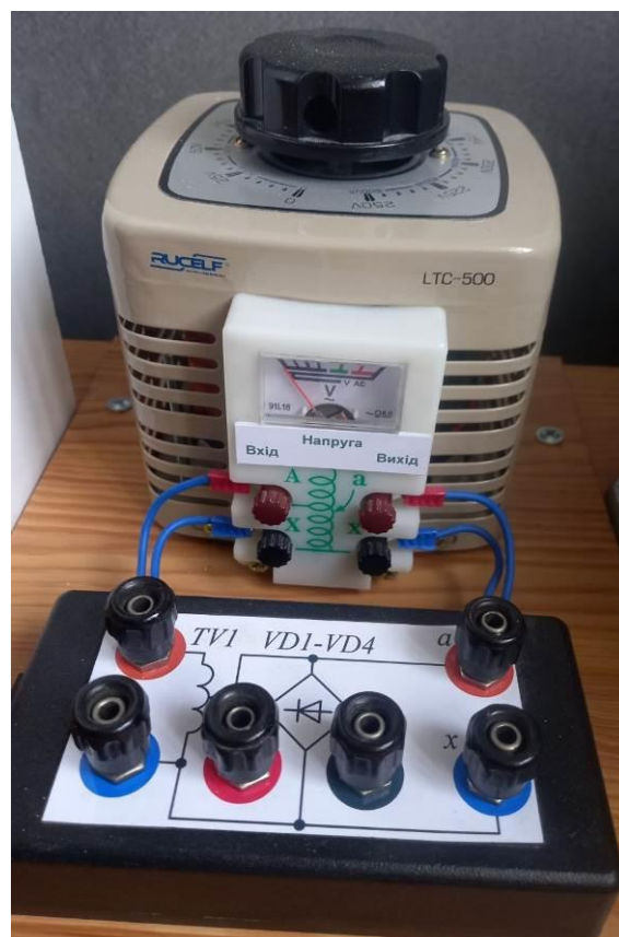
Рисунок 1.9 – Автотрансформатор, що використовується для проведення дослідів
