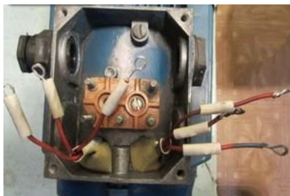
Рисунок 1.2 – Шість виводів обмотки статора асинхронного двигуна
